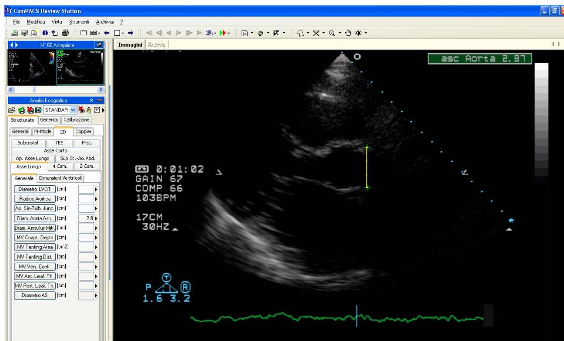
Per effettuare la misura, premere il tasto relativo alla misura che si desidera effettuare. Posizionare poi il cursore del mouse sul punto di partenza della misura, esso prenderà la forma di una penna. Cliccare sul punto e muovere il mouse nel punto di chiusura della misura. Cliccare nuovamente e la misura sarà effettuata e il suo valore verrà riportato nel relativo campo. Per misure che vengono normalmente prese
