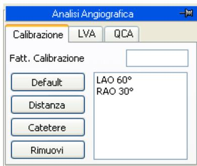
La calibrazione di default può essere effettuata premendo il pulsante *Default* nel riquadro Calibrazione. Nel riquadro bianco apparirà una lista di nomi corrispondenti a calibrazioni di default impostate nel programma. Per attivarne una selezionarla con il pulsante sinistro del mouse. Il valore corrispondente al nome selezionato verrà visualizzato nel riquadro in alto.
