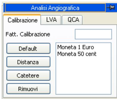
La calibrazione su di una distanza nota può essere effettuata premendo il pulsante *Distanza* nel riquadro *Calibrazione*. Nel riquadro bianco apparirà una lista delle distanze note impostate nel programma che possono essere selezionate con il mouse.
