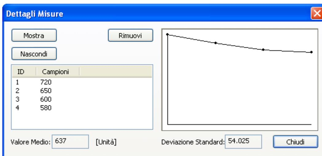
E' inoltre possibile rimuovere un valore di misura, se errato, semplicemente selezionandolo e cliccando sul tasto *Rimuovi*. I tasti *Mostra* e *Nascondi* servono per mostrare o nascondere i valori nel ECG.
