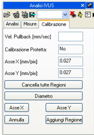
Se, al passaggio del mouse, nessuna informazione appare nel riquadro allora l'immagine è da calibrare. Per calibrare l'immagine è necessario stabilire (agendo sui tasti *Asse X* e *Asse Y*) i valori da assegnare agli assi componenti l'immagine.
