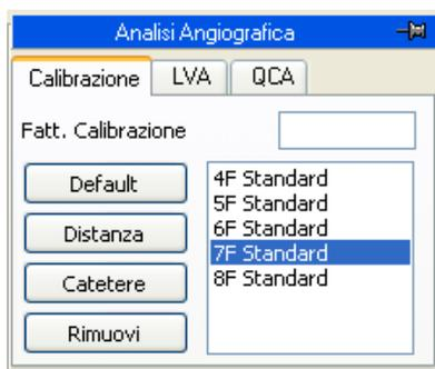
La calibrazione su di un catetere noto può essere effettuata premendo il pulsante *Catetere* nel riquadro *Calibrazione*. Nel riquadro bianco apparirà una lista di cateteri di dimensione nota impostati nel programma. Inizialmente sarà selezionato l'ultimo catetere utilizzato precedentemente ed evidenziato in blu. Per attivarne un altro selezionarlo con il pulsante sinistro del mouse.
