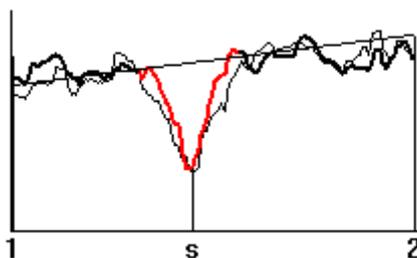
Inoltre, con un doppio click del mouse sulla funzione di diametro il programma visualizzerà i risultati dell'analisi densitometrica. L'analisi geometrica viene riportata in sovrapposizione con un tratto più leggero per un confronto diretto. Un ulteriore doppio click riporta alla visualizzazione impostata in precedenza.
