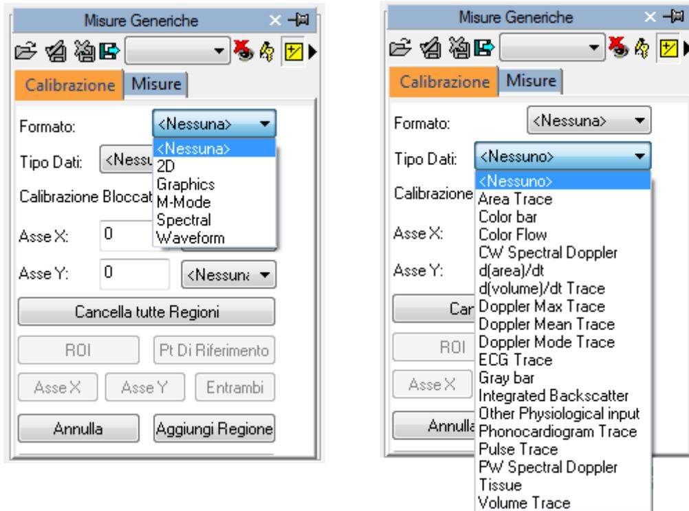
Successivamente è necessario stabilire (agendo sui tasti *Asse X* e *Asse Y*) i valori da assegnare agli assi componenti l'immagine. Ad esempio, nel caso di un'immagine Doppler, bisogna assegnare un valore di tempo all'asse X e di velocità all'asse Y. Per immagini 2D, che dispongono della stessa unità di misura per entrambi gli assi, è altresì possibile calibrare entrambi gli assi con un unico segmento diagonale mediante il tasto *Entrambi*.
