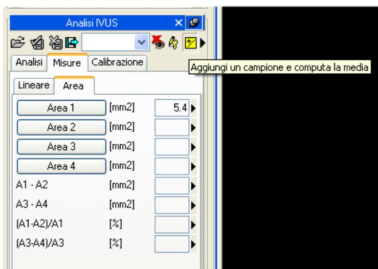
Nel caso di misure ripetute il valore mostrato accanto alla misura è quello della media aritmetica. Comunque rimane possibile visualizzare tutti i campioni acquisiti. A fianco di ogni misura c'è una freccia che permette di accedere a un menù di gestione della singola misura:
