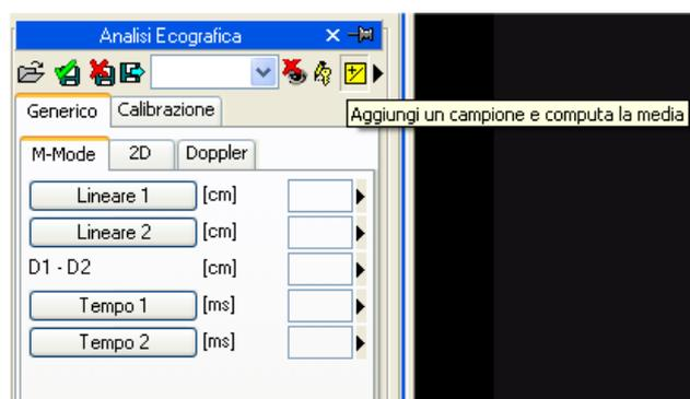
Nel caso di misure ripetute il valore mostrato accanto alla misura è quello della media aritmetica. Comunque rimane possibile visualizzare tutti i campioni acquisiti. A fianco di ogni misura c'è una freccia che permette di accedere a un menù di gestione della singola misura:
