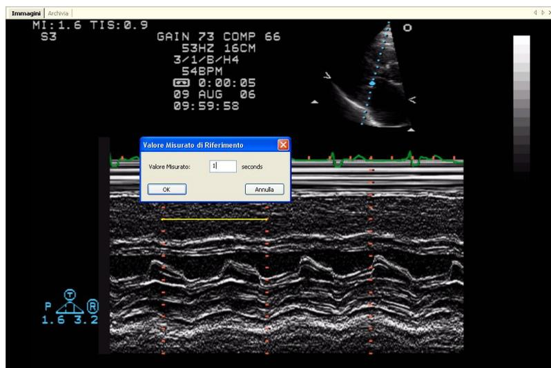
Il cursore sull'immagine cambierà in una penna e consentirà di tracciare un segmento premendo il pulsante sinistro una prima volta nel punto iniziale e poi una seconda volta in quello finale. Al termine una finestra di dialogo vi chiederà di indicare la dimensione del segmento tracciato nell'unità di misura apposta.
