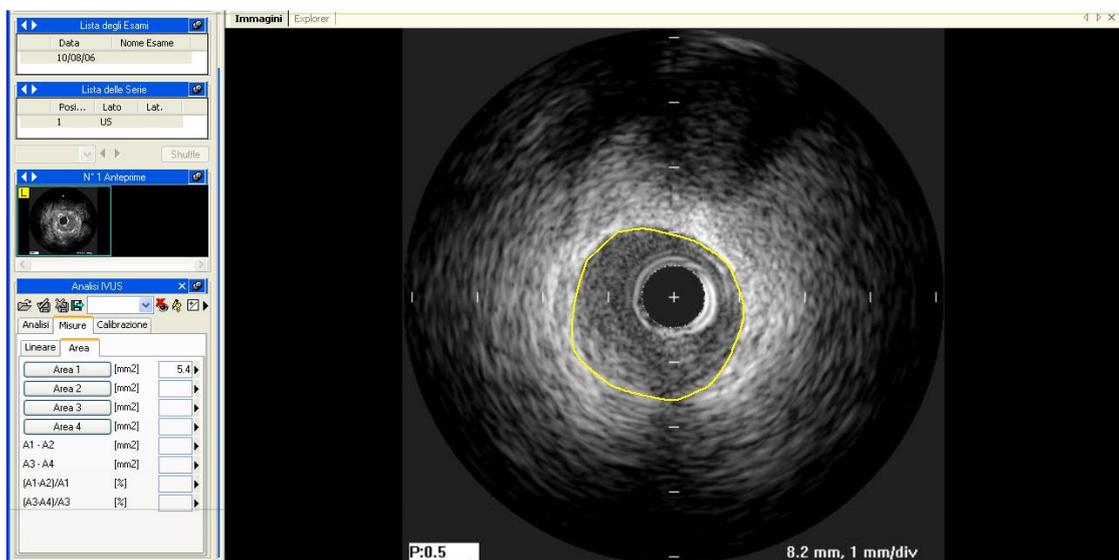
Nel caso di misura di un angolo, il sistema utilizza automaticamente il centro dell'immagine come punto di riferimento. E' quindi sufficiente fare un click su due punti nell'immagine, muovendosi in senso orario, per misurare l'angolo corrispondente. In caso di errore, agendo col tasto destro del mouse, si possono cancellare punti o, con un doppio click, annullare la misura.
