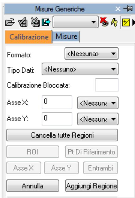
Nel caso in cui nessuna informazione viene visualizzata al passaggio del mouse sull'immagine, allora è necessario effettuare la calibrazione.
